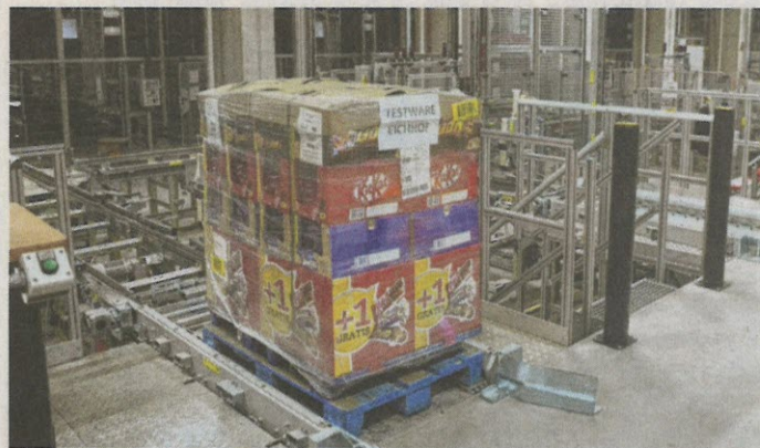
Anlage im Testbetrieb mit beladenen Rollcontainern. Es gibt 16 Wareneingangstore. Die Einlagerung läuft voll- und teilautomatisch. Fotos: Benjamin Steinhausen
