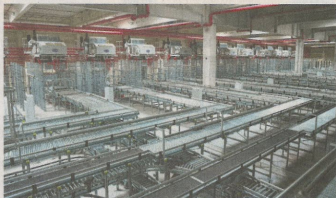
Das imposante Herzstück des Lagers: Die OPM – die Order Picking Machine – auf mehrere Ebenen bestückt Rollcontainer nach Bestellung und sogar nach Laufrichtung des jeweiligen Marktes.
